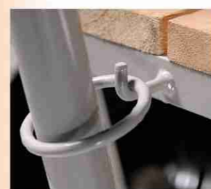
Dispositivo de travamento de frenagem por argola (tradicional)
