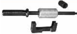
CR 187 Extrator de bico injetor para: MWM: série 10 e 229 Sprint e Mercedes (acompanha 2 sacadores Interchangeáveis)
