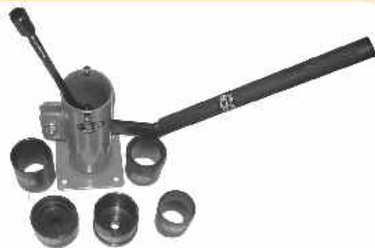
CR 177 Ferramenta para posicionar as polias de comando de válvulas em PMS. Audi: 2.4 / 2.6 / 2.7 / 2.8 - 12 e 30V Passat 30V
